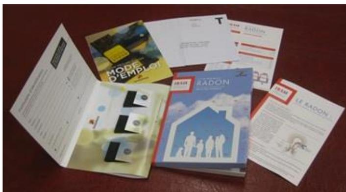
Composition d'un kit de mesure du radon
